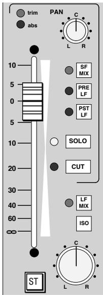
The Small Fader連接到電腦的自動化控制系統(Automation)。他的Pan旋鈕位於右上方，通常控制聲音在左右喇叭（或基數偶數通道）之間的定位，若另外開啟LCR panning，則可以將輸出定位在額外的中置喇叭上。
