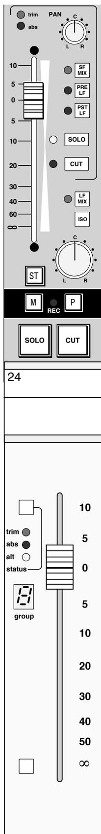
The Large Fader (右圖) 同樣也連接到電腦的自動化控制系統 (Automation)。Large Faders經過指定而被控台中央的八個Group Fader所控制。
