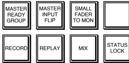
SL 9000設定有：RECORD, REPLAY, MIX and RECORD + MIX (overdub)。而SMALL FADER TO MON(ITOR)和MASTER INPUT FLIP 也會影響到I/O模組的訊號流。
