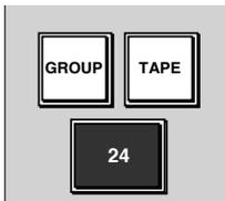
監聽路徑共有兩種來源可以選擇。GROUP選擇該模組的Group Output，也就是送去給Multitrack的訊號(編按：Patch H行的訊號，如果沒插線，則訊號直接來自G行，也就是上面的Routing, Matrix作為來源。)
