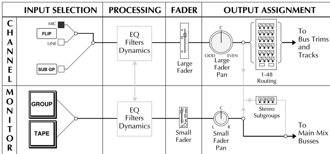
在這個模式下，Mic input訊號是走到Large Fader 和Pan 之後進到Multitrack Routing Matrix (Channel path)然後再從Group mix amp和關聯到該軌的Trim control到Multitrack裡面 (例如：Track 7的訊號是從 Module 7的 Group Output出來的)。
